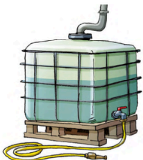
Cuve de récupération d'eau de pluie
