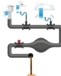
Si le bouchon est dans la partie privative, il y a risque de déformation des parois de la canalisation et de débordement dans l'habitation d'eaux usées. Si les lingettes parviennent dans la partie publique elles peuvent obstruer les canalisations, bloquer les pompes des postes de pompage des eaux usées, colmater les grilles situées en tête de la station d'épuration. Ces risques engendrent mauvaises odeurs et débordements temporaires d'eaux usées dans le milieu naturel.
