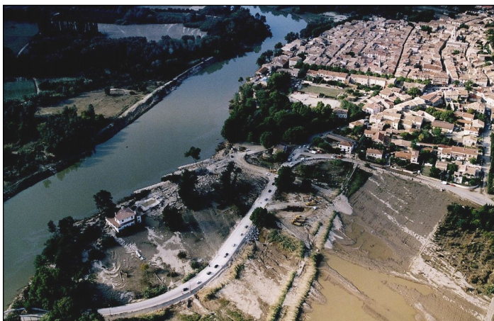
Aval du verrou de Montfrin. Le Gardon s'est brusquement élargit dans la plaine du Rhône, les traces d'un hydrodynamisme fort sont visibles à plusieurs centaines de mètres du lit mineur (photo Strategis)
