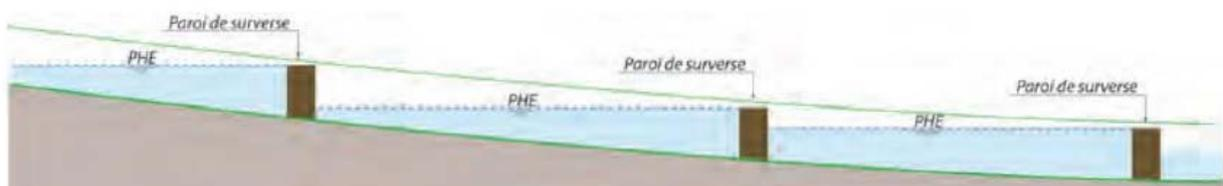
Profil en long d'une noue sur un terrain en forte pente
